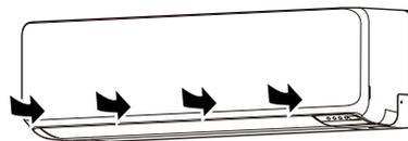
**REMARQUES :** Si de la saleté s'accumule sur le filtre à air, cela réduit le flux d'air, l'efficacité de fonctionnement diminue et le bruit augmente.
